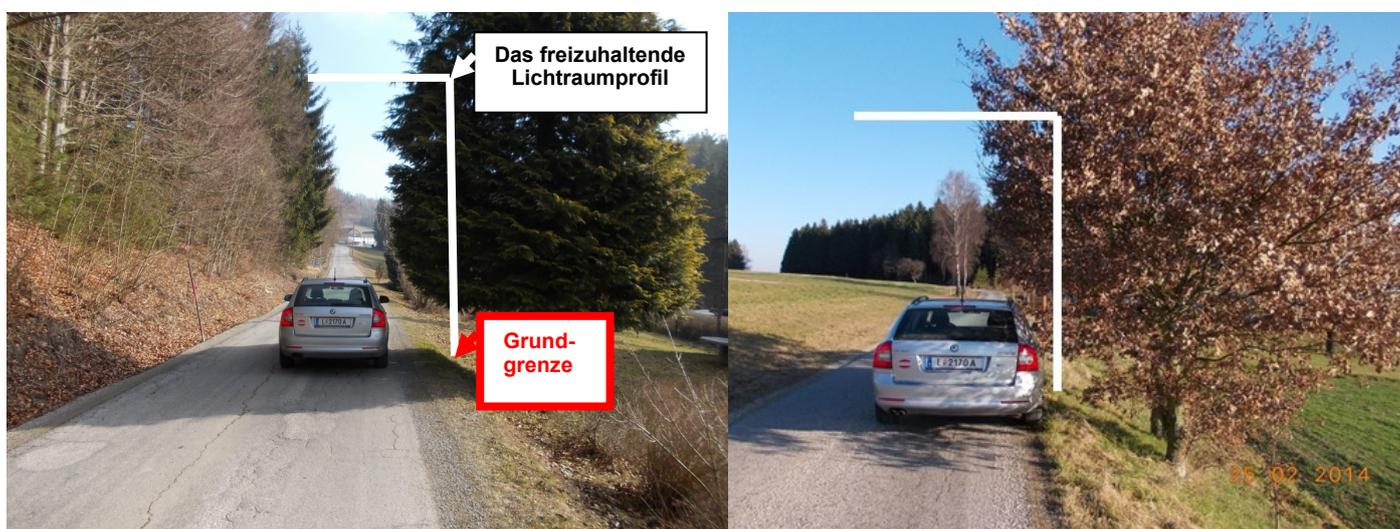
Wir weisen darauf hin, dass eventuelle Schäden an Fahrzeugen die durch Nichteinhaltung des Lichtraumprofils entstehen sowie eventuelle Personenschäden die bei Unfällen aufgrund uneinsehbarer Kreuzungsbereiche entstehen, ausnahmslos an die jeweiligen Grundstücksbesitzer weitergeleitet werden.
